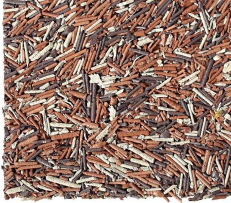
Структура покрытия обладает хорошей водопроницаемостью и паро-пропускной способностью, т.е. дышит, без значительного ухудшения своих физико-механических свойств.
