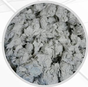
**BMC (Bulk Molding Compound)** – материал в виде рыхлой бесформенной массы, в состав которой входят: ненасыщенные полиэфирные смолы, наполнители, добавки и стекловолокно. Используется при изготовлении изделий сложной конфигурации.
