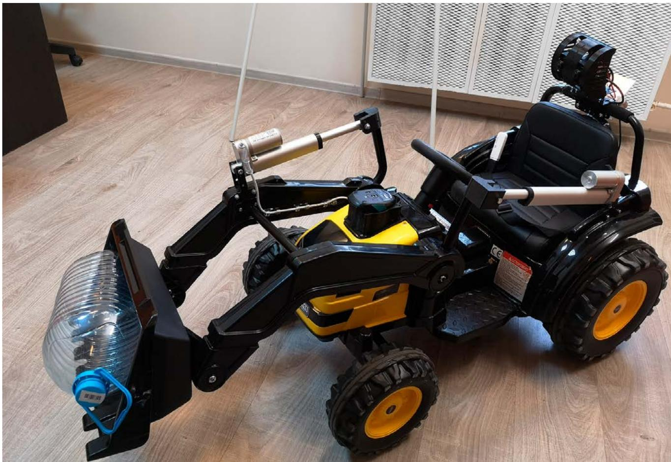
В качестве прототипов в лабораториях ИТИС используют портативные мобильные устройства, в том числе — маленькую копию погрузчика
